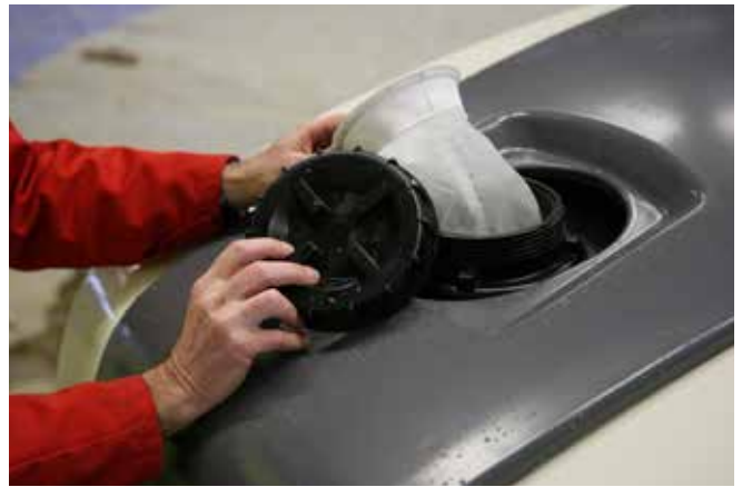
El tanque de agua tiene un gran orificio para facilitar el llenado.
