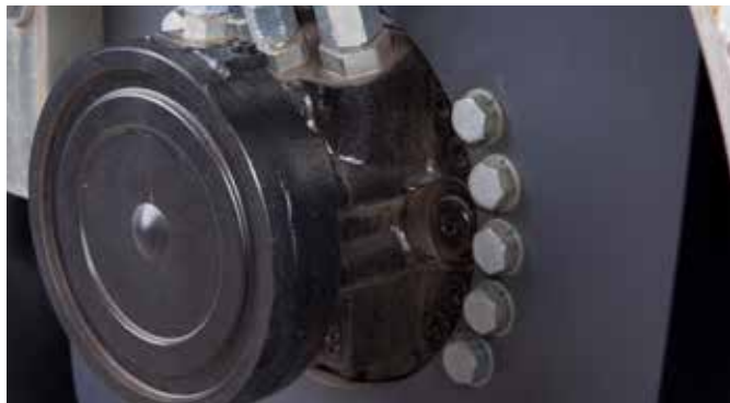
Ambos rodillos estan equipados con frenos de seguridad (o sobre el rodillo + ruedas en versiones combi). Los frenos se bloquean automaticamente en caso de fallo del motor, del sistema hidraulico o del circuito electrico.
