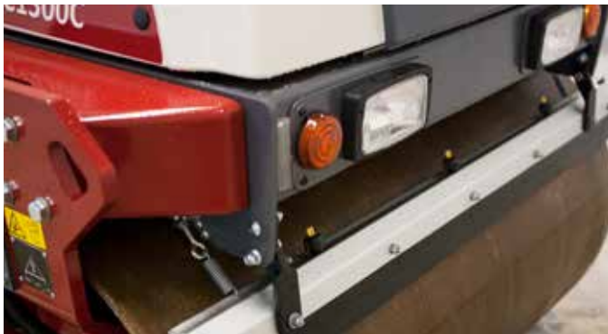
Tres boquillas en CC1300. Tres filtros en el sistema de riego aseguran la limpieza del agua. El temporizador de riego es estandar.
