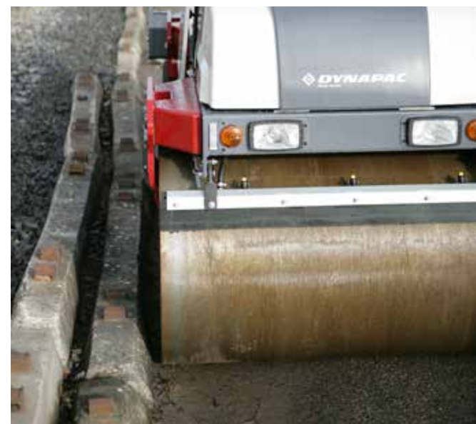
Excelente altura libre de bordillos de los rodillos facilitan el trabajo muy cerca de espacios dificiles. Visibilidad excelente en los bordes de rodillos facilitan y mejoran los resultados de compactación.
