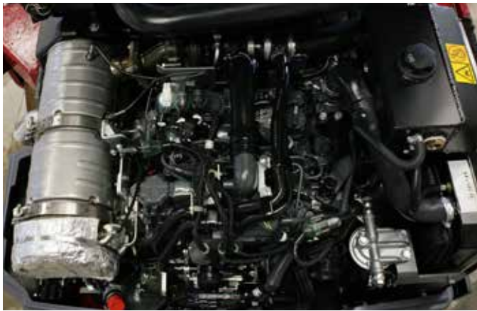
Motor Kubota refrigerado por agua muy silencioso. El capó robusto y de fácil apertura ofrece una gran accesibilidad.
