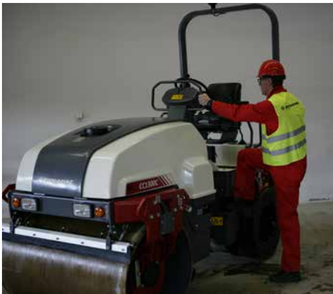
Seguridad en los peldaños y ergonomia con barandillas de apoyo.
